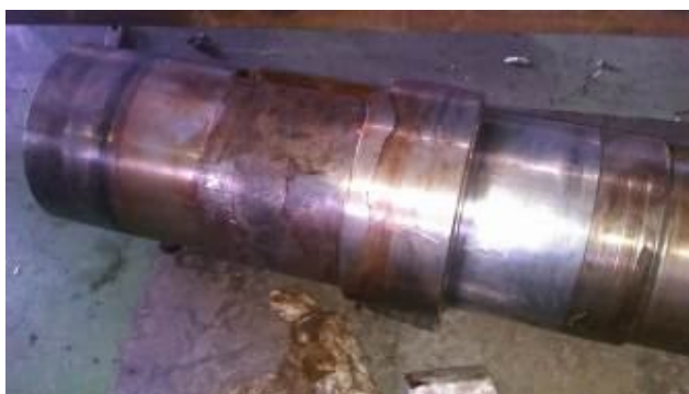
شکل 6- وجود زنگار در محل نشیمن شفت
