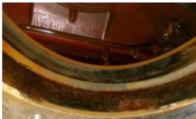
شکل 7- زنگ‌زدگی در محل نشیمن بیرینگ
