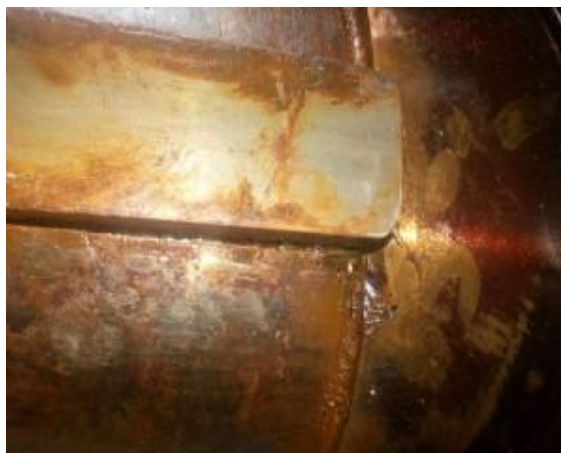
شکل 10- زنگ زدگی در محل نشیمن چرخ دنده
