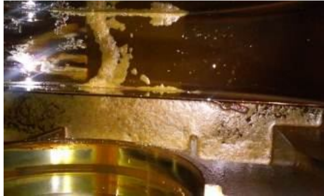
شکل 8- وجود کف در روغن گیربکس
